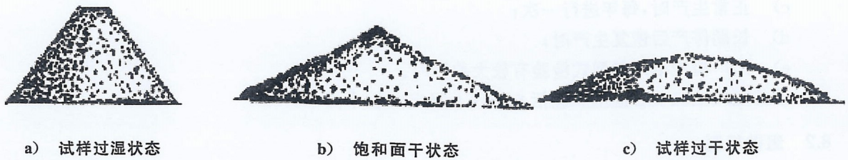
图4 天然砂饱和面干状态示意图
